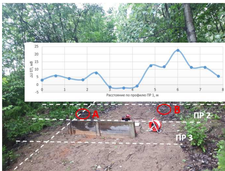
Рис. 4. Результаты ЕП на профиле 1. Максимумы связаны с областями контаминации, минимум наблюдается в месте расположения насыпного грунта.
