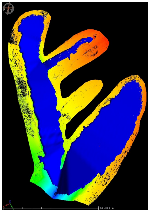
Сур. 6. Жыраның 3D моделінің ішкі көлемін анықтау үшін толтырылған пішін.
