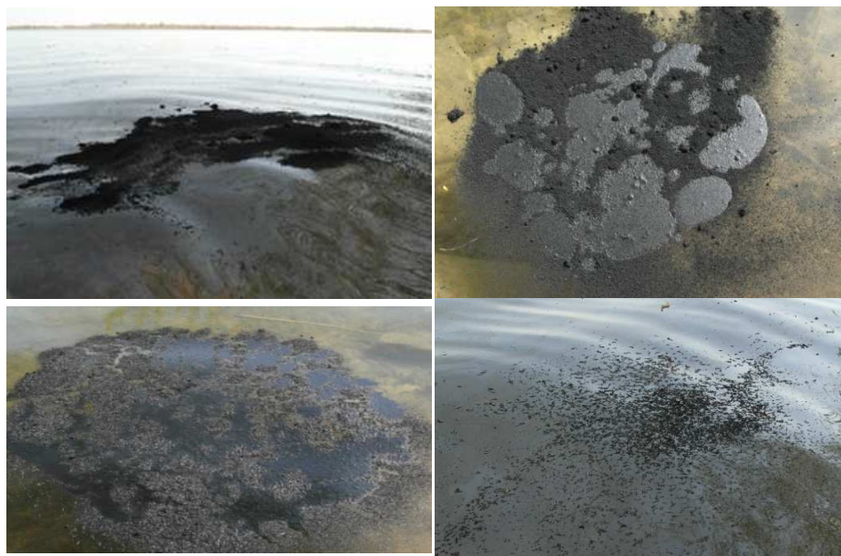
Рис. 1. Использование термографенита в промышленных условиях для ликвидации разливов нефти.
