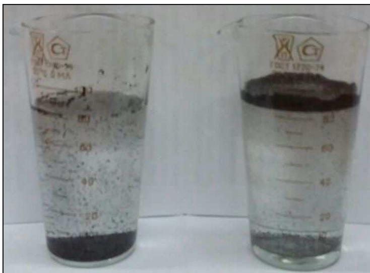
Рис. 4. Сравнение плаваемости природного графита марки ГЛ-1 (а) и ТРГ (б).
