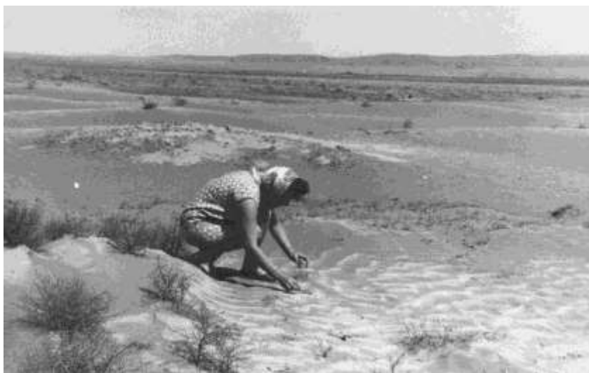
Рис. 5. Взятие проб песка на влажность из поверхностного слоя. Хорошо виден пятнистый характер высыхания поверхности.
