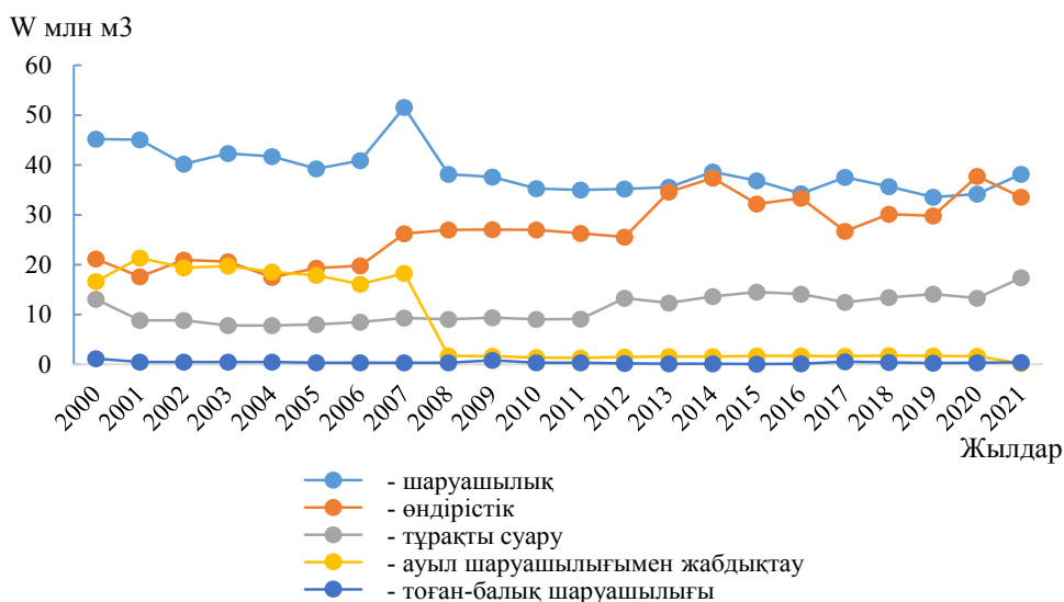
Сур.2. Экономика салалары бойынша 2000...2021 жылдарға арналған Тобыл өзені бассейнінде шаруашылық қажеттіліктері үшін су алу.
