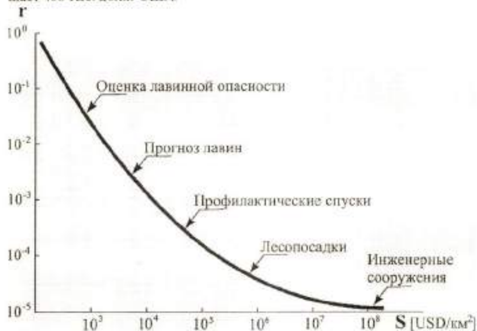
Рис. 2. Зависимость индивидуального лавинного риска \Gamma от стоимости противолавинных мероприятий S
