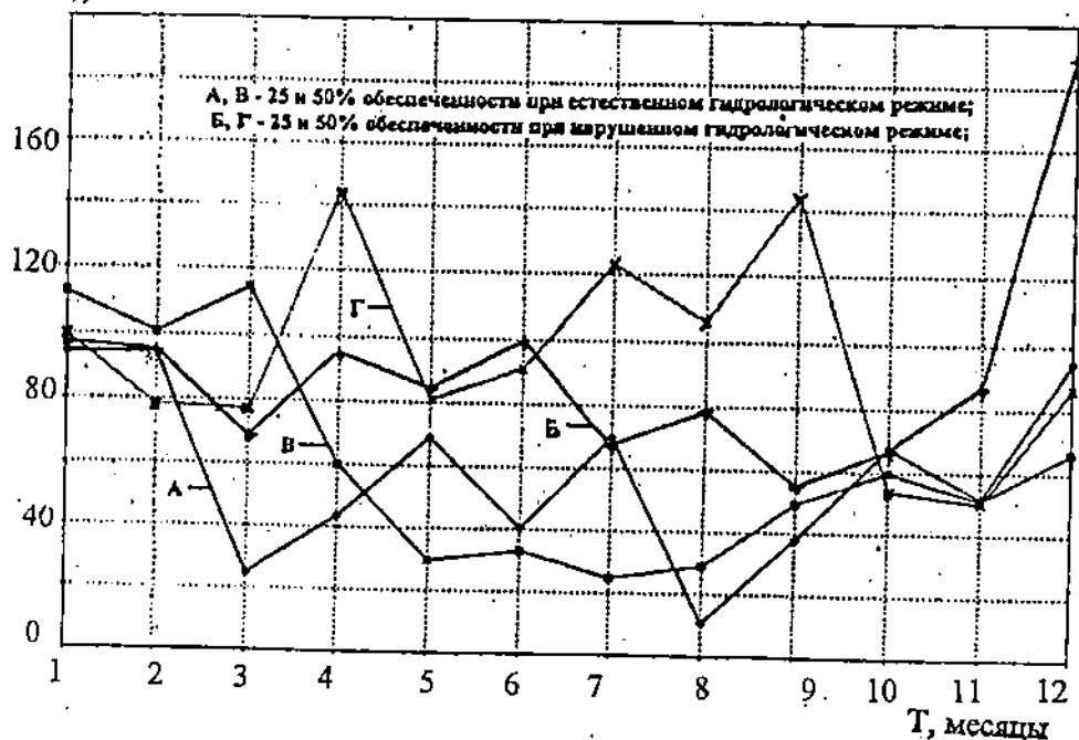
Рис. Внутригодовая динамика изменения  $\text{SO}_4^{2-}$  воды реки Или в створе ур. Капшагай при естественном и нарушенном гидрологическом режимах
