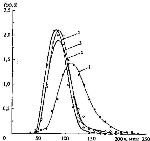
Рис. 4. Изменение дифференциальной кривой функции распределения частиц песка по размерам  $f(x)$  с высотой переноса  $z$  в слое сальтации.
