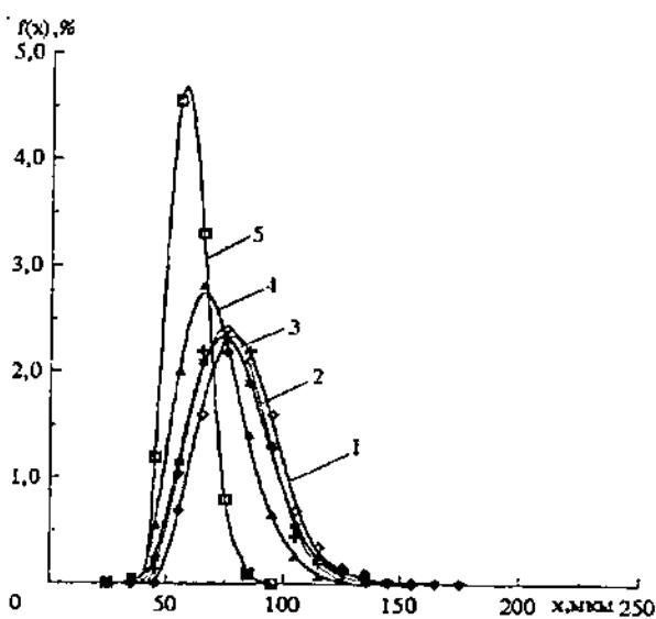
Рис. 5. Изменение дифференциальной кривой функции распределения частиц песка по размерам  $f(x)$  с высотой переноса  $z$ , выше слоя сальтации.
