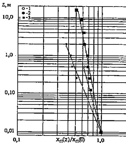
*Рис. 1. Изменение с высотой переноса соотношения среднего геометрического размера частиц песка на высотах и на деятельной поверхности.*
