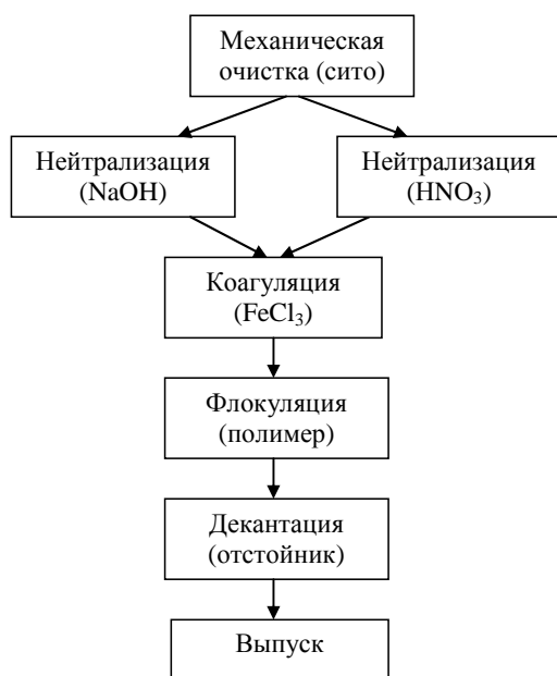
Рис. 2. Предлагаемая технологическая схема очистки фильтрационной воды полигона ТБО г. Астаны.
