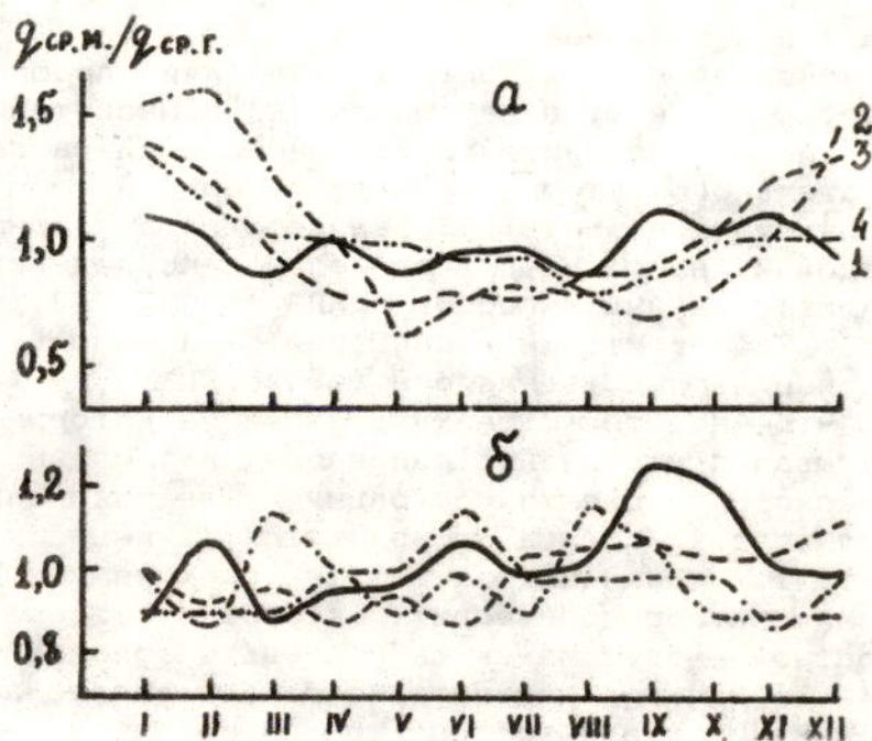
Рис. 1. Многолетний годовой ход отношений  $q_{ср.м.}/q_{ср.г.}$  концентраций пыли (1),  $SO_2$  (2),  $CO$  (3),  $NO_2$  (4) в атмосфере г. Алматы (а) и г. Капшагай (б)
