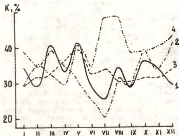
Рис.2. Многолетний годовой ход коэффициентов вариации ( $K, \%$ ) средних суточных концентраций пыли (1),  $SO_2$  (2),  $CO$  (3),  $NO_2$  (4) в воздушном бассейне г. Алматы
