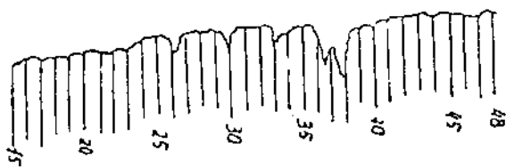
Рис.3. Рентгенограмма продукта остеклования пробы №198 (ситалл)
