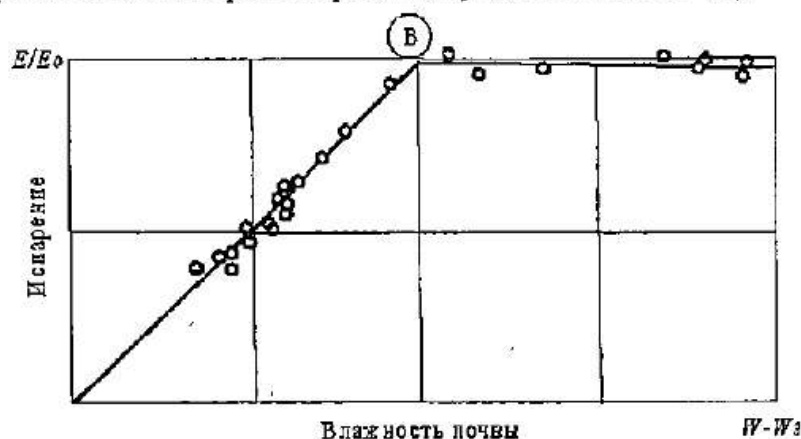
Рис. 2. Зависимость отношения испарения к испаряемости от влажности почвы на посевах пшеницы (М.А. Великанов, 1964 г). В - влажность почвы, соответствующая полной потребности растений. Точками нанесены экспериментальные данные.
