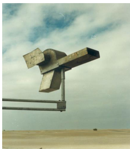
Рис. 2. Пескоуловитель для градиентных измерений переноса массы песка на метеорологических мачтах.
