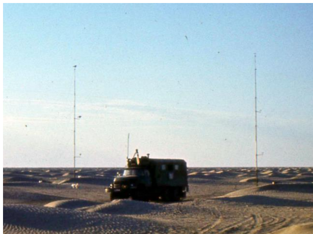
Рис. 1. Передвижная метеорологическая станция с градиентным шестнадцатиметровыми мачтами на осушенном дне Арала.
