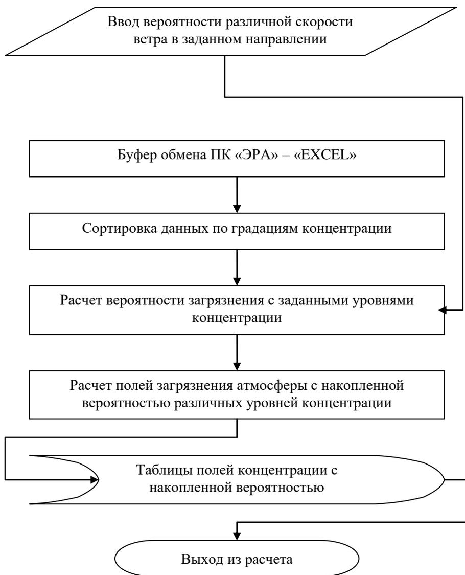
Рис. 2. Алгоритм расчета полей концентрации ЗВ с накопленной вероятностью.
