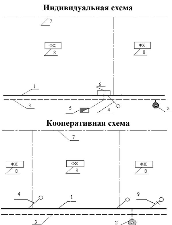
Рис. Схемы использования дренажных вод на орошение. 1 – оросительный канал, 2 – скважина вертикального дренажа, 3 – лоток, 4 – водовыпуск, 5 – насос, 6 – аванкамера, 7 – граница фермерского хозяйства, 8 – орошаемая площадь, 9 – шлюз – регулятор.
