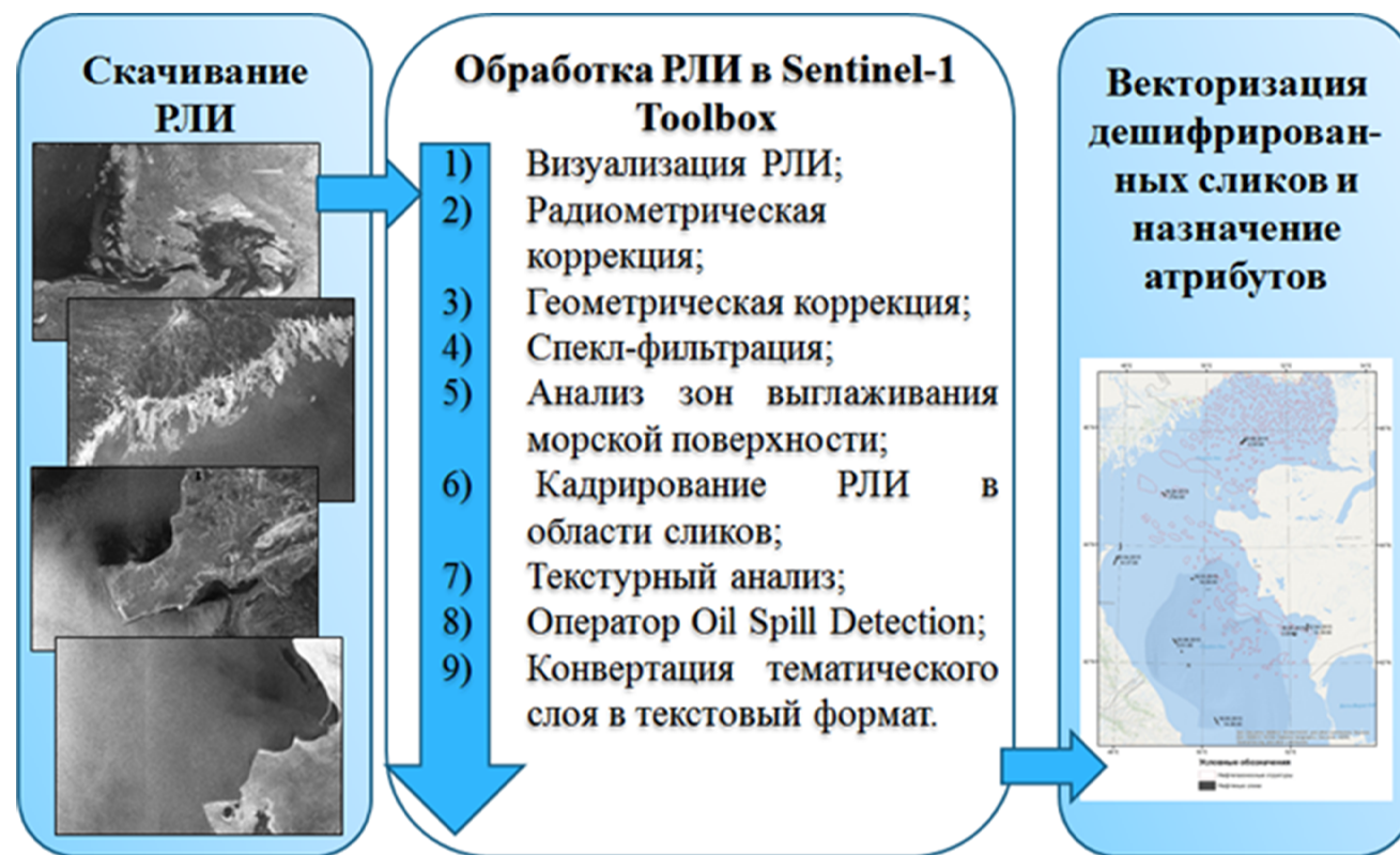
Рис. 1. Алгоритм распознавания возможных нефтяных пленок на морской поверхности.
