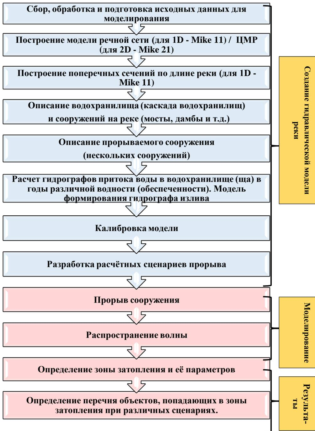
Рис. 1. Алгоритм расчета распространения волны прорыва при гидродинамической аварии.
