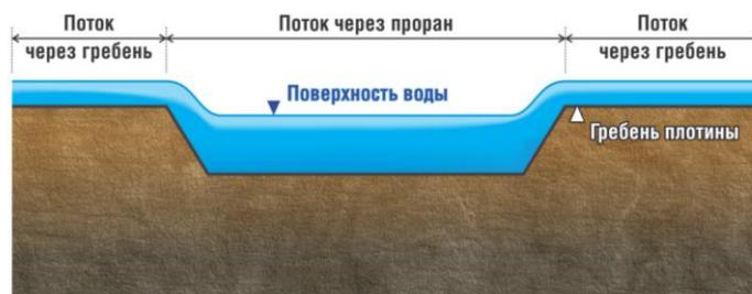
Рис. 5. Комбинированный поток через проран и гребень.
