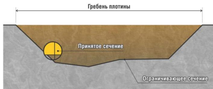
*Рис. 8. Корректировка сечения трубы.*
