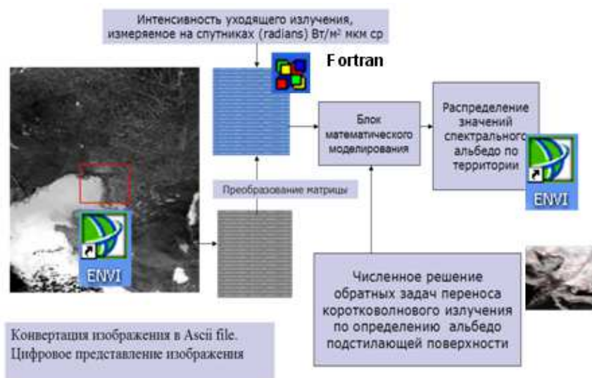
Рис. Алгоритм применения спутниковой информации для расчета физических параметров атмосферы.
