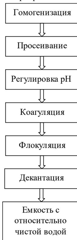
*Рис. Технологическая схема очистки фильтрационной воды.*
