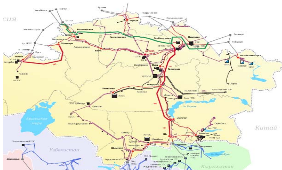
Рис. 2. Объединенная энергосистема Казахстана. Источник – «KEGOC».
