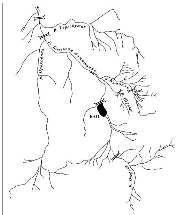
Рис. 3. Схема расположения существующих и предлагаемых селезащитных сооружений в бассейне р. Большой Алматинки.
