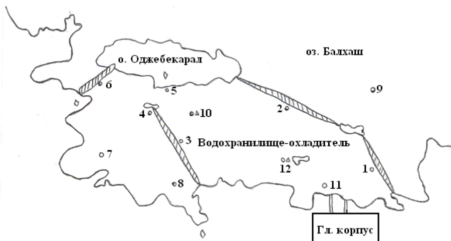
Рис. 1.- Схема ВО ЮКРЭС с пунктами отбора проб воды, донных отложений и почв. о – пункты отбора проб воды; Δ - донных отложений; ◇ - почв; о1 – Восточная; о2 – Северная; о6 – Западная; о3 – струенаправляющая плотина.
