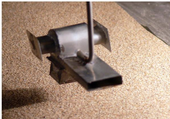
*Рис. 3. Малогабаритный уловитель песка над поверхностью песка в аэродинамической трубе.*
