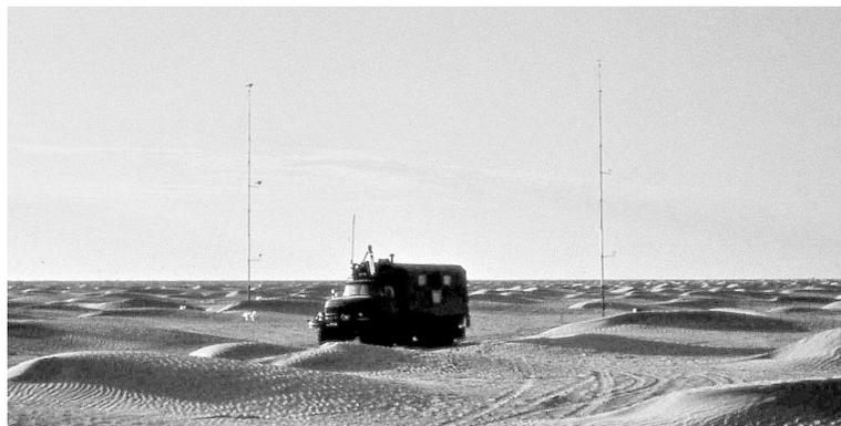
*Рис. 2. Передвижная метеорологическая станция с метеорологическими мачтами для градиентных измерений на осушенном дне Арала.*
