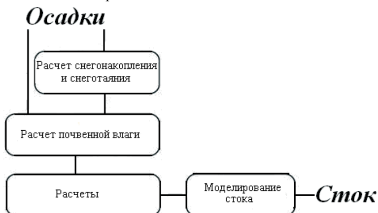
Рис. 1. Схема структуры HBV-модели.
