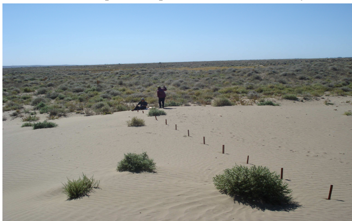
Рис. 2. Юго-западная часть среднебугристого бархана. Установка измерительных реек.
