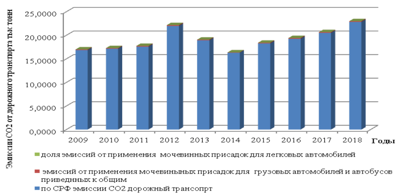
Рис. 5. Эмиссии CO 2 , образованные от работы мочевиных катализаторов, в сравнении с общими эмиссиями CO 2 от дорожного транспорта.
