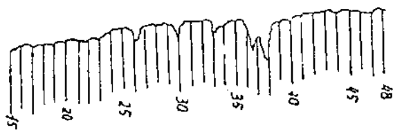
Рис.3. Рентгенограмма продукта остеклования пробы №198 (ситалл)
