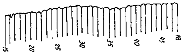
Рис.6. Рентгенограмма продукта остеклования пробы №209 (стекло)
