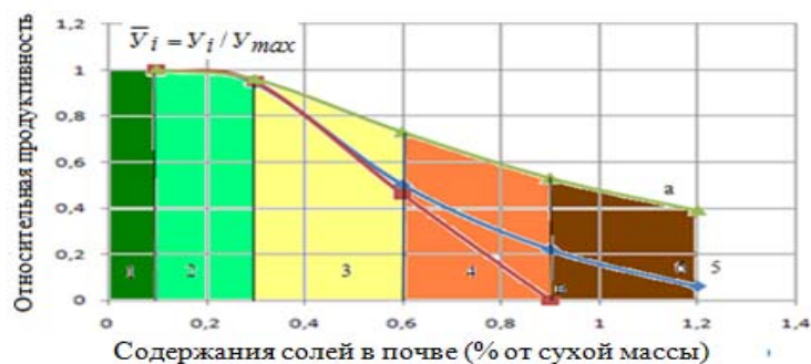
Рис. 10. Зависимость урожайности ( \bar{Y} = Y_i / Y_{\max} ) от содержания солей в почве (% от сухой массы): а – люцерна; б – хлопчатник; в – кукуруза на зерно; 1 – незасоленные; 2 – слабо засоленные; 3 – средне засоленные; 4 – сильно засоленные; 5 – очень сильно засоленные.
