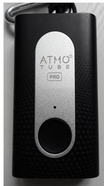
Рис. 4. Мобильный прибор измерения качества воздуха
