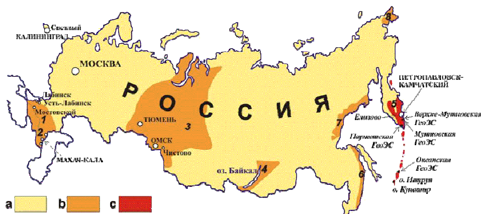
Рис. 4. Геотермическое районирование России. а – районы пригодные для теплоснабжения зданий с помощью тепловых насосов; б – районы перспективные для «прямого» использования; с – районы современного вулканизма наиболее перспективные для «прямого» использования, выработка тепла и электроэнергии на бинарных установках, а также создание крупных ГеоЭС на парогидротермальных месторождениях. 1 – Северный Кавказ (платформенная провинция), 2 – Северный Кавказ (альпийская провинция), 3 – Западная Сибирь, 4 – Прибайкалье, 5 – Курило-Камчатский регион, 6 – Приморье, 7...8 – Охотско-Чукотский вулканический пояс.
