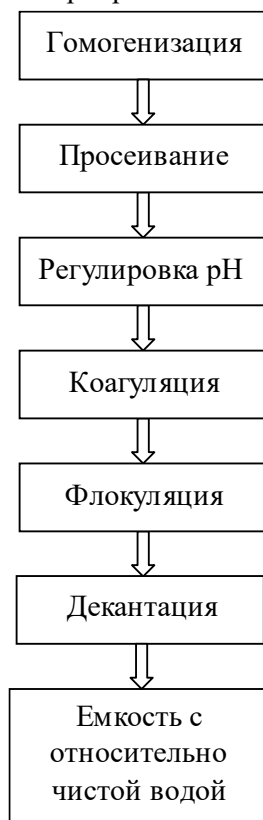
Рис. Технологическая схема очистки фильтрационной воды.
