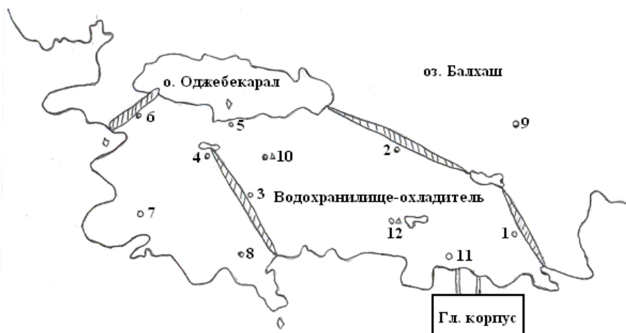
Рис. 1.- Схема ВО ЮКРЭС с пунктами отбора проб воды, донных отложений и почв. о – пункты отбора проб воды; Δ - донных отложений; ◇ - почв; о1 – Восточная; о2 – Северная; об – Западная; о3 – струенаправляющая плотина.
