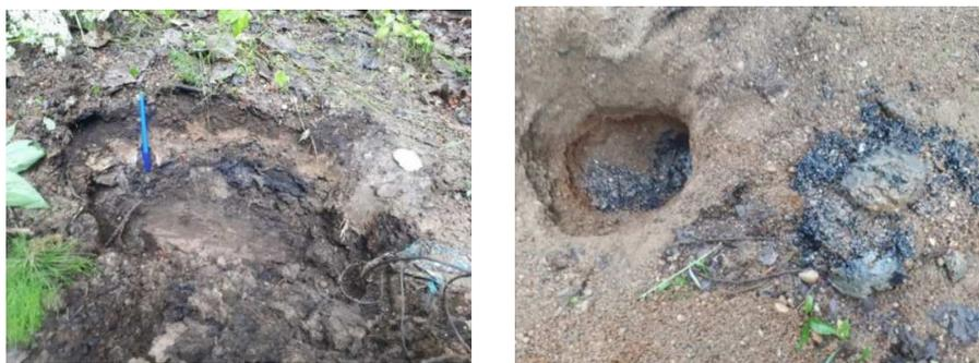
Рис. 3. Визуально определяемые следы нефтяного загрязнения. Слева – прослойки, линзы мазута, битума на поверхности и на глубине около 15...20 см (точка А на рис. 2). Справа – загрязненный нефтью слой грунта на глубине около 50 см под толщей гравия (видимо, отсыпанного для скрытия загрязнения) (точка В на рис. 2).
