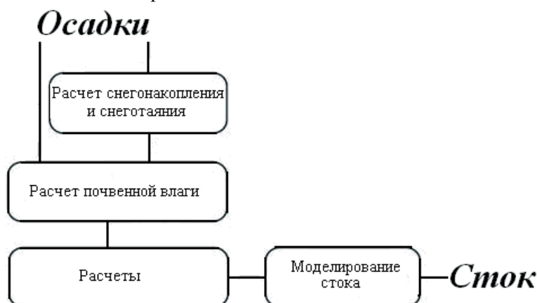
Рис. 1. Схема структуры HBV-модели.
