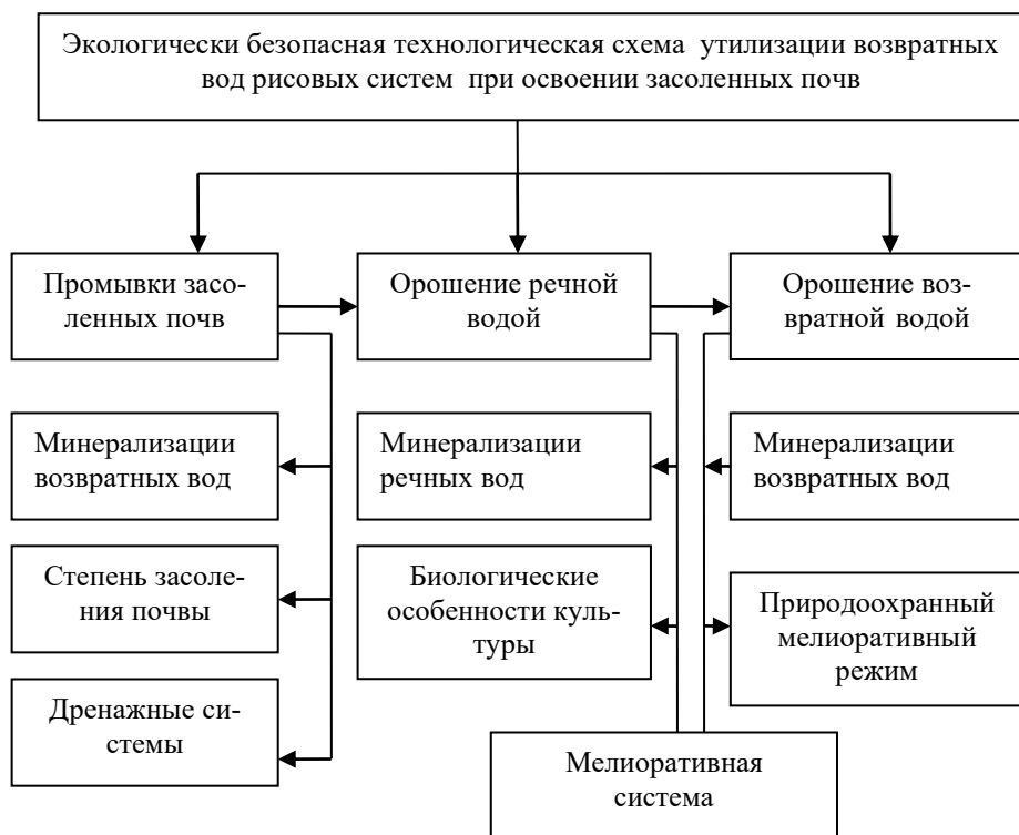
Рис. 2. Структурная схема технологии экологически безопасного использования возвратных вод рисовых систем для освоения засоленных почв.
