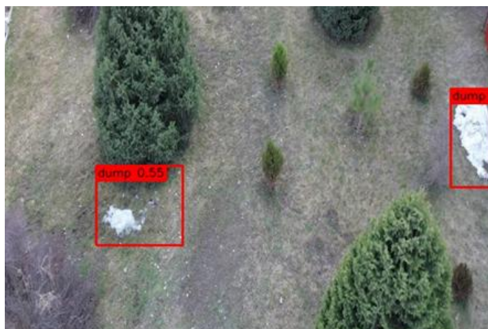
Рисунок 6. Ошибочная классификация скопления снега как мусора
