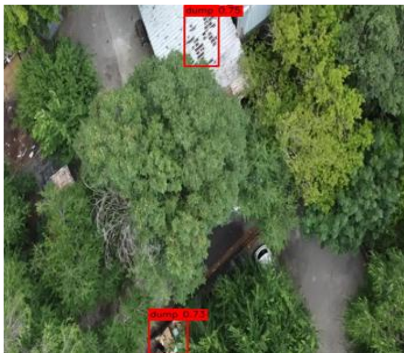
Рисунок 5. Ложное срабатывание модели: детекция фрагмента крыши как скопления ТБО
