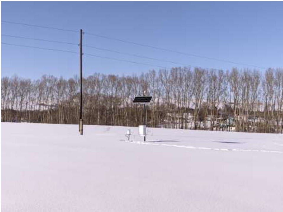
Рисунок 2. Автоматическая агрометеорологическая станция на территории ТОО «Алтын Казан и К» (Фото Нурекинов, февраль 2025 г.)
