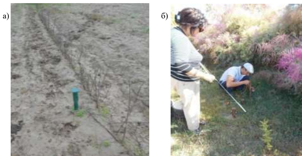
а - наблюдательная скважина, б - куст разnogлубинных скважин-пъезметров
