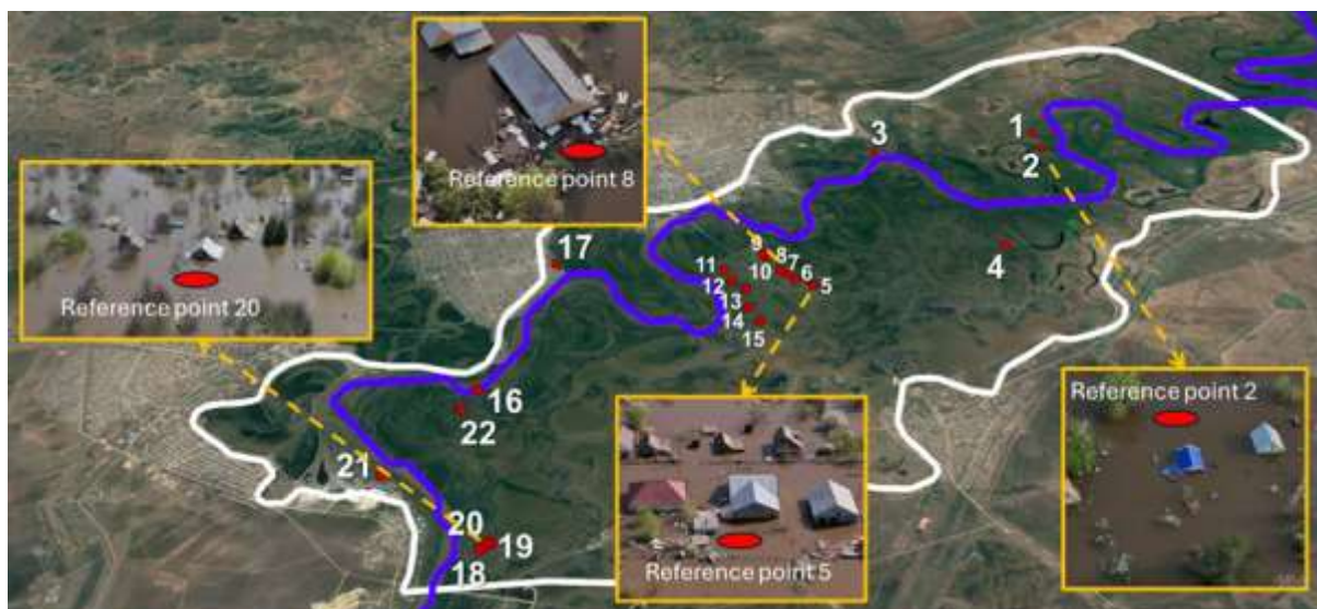
Рисунок 3. Двадцать две контрольные точки, которые использовались для сравнения глубин затопления, а также увеличенные снимки с беспилотника выбранных точек отбора проб
