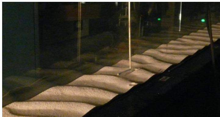
Рис. 5. Измерение скорости потока над гребнем эоловой ряби.
