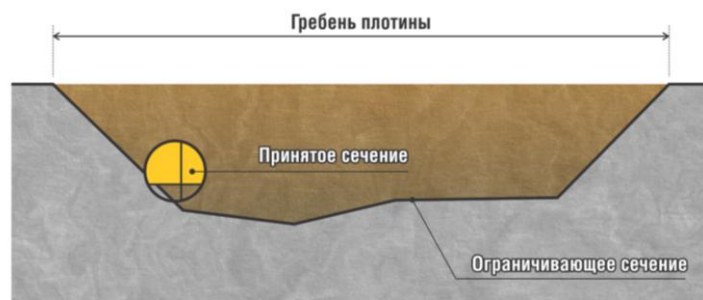
Рис. 8. Корректировка сечения трубы.
