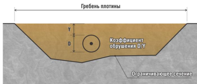
Рис. 9. Авария с образованием грифона. Схема и определение момента обрушения (Коэффициент обрушения – предельное отношение диаметра трубы D к толщине свода Y ).
