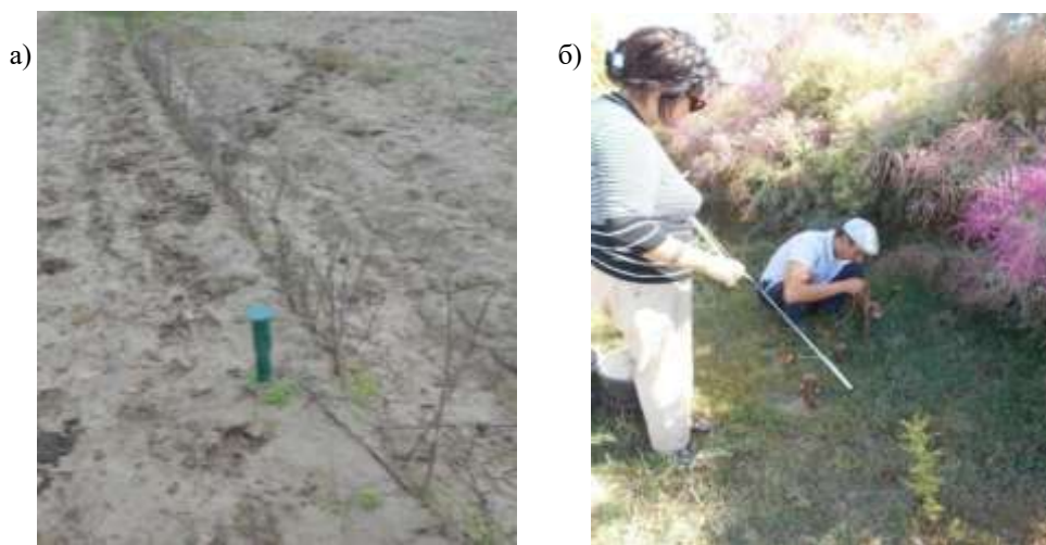
а - наблюдательная скважина, б - куст разнотрубинных скважин-пьезометров
