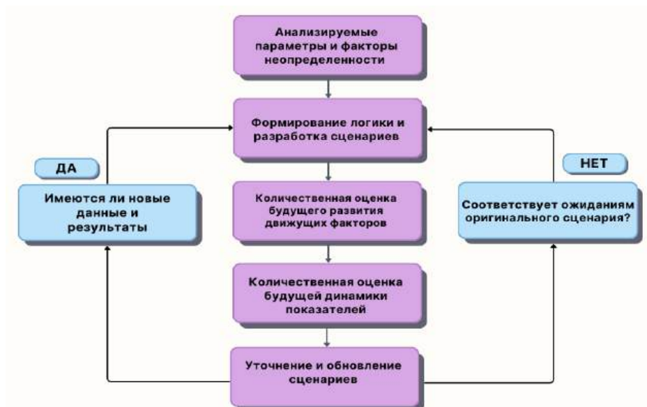
Рисунок 1. Итеративная концептуальная схема разработки и уточнения сценариев развития водохозяйственных систем
