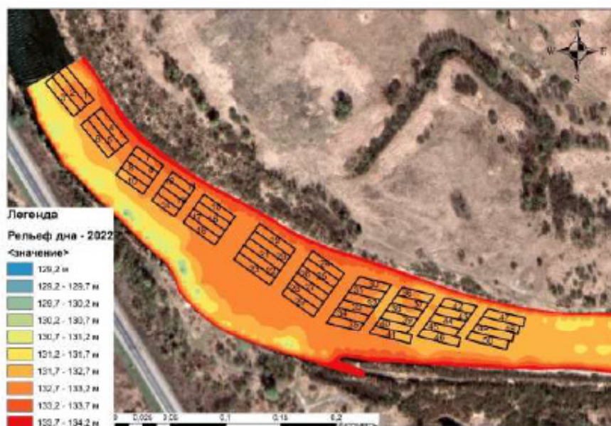
Рис.12. Номера и размещение прорезей с учетом технологических разрывов
