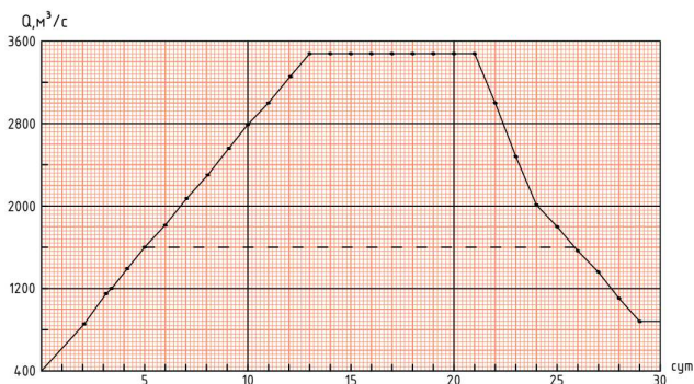
Рис. 1. Эталон гидрографа природоохранного попуска из Шульбинского водохранилища в русло р. Иртыш (выше горизонтальной пунктирной линии зона затопления поймы в створе г. Павлодара с продолжительностью 21 суток).
