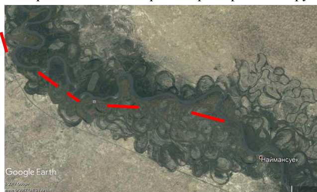
Рис. Фрагмент нижнего течения р. Каратал и мероприятия по спрямлению русла.
