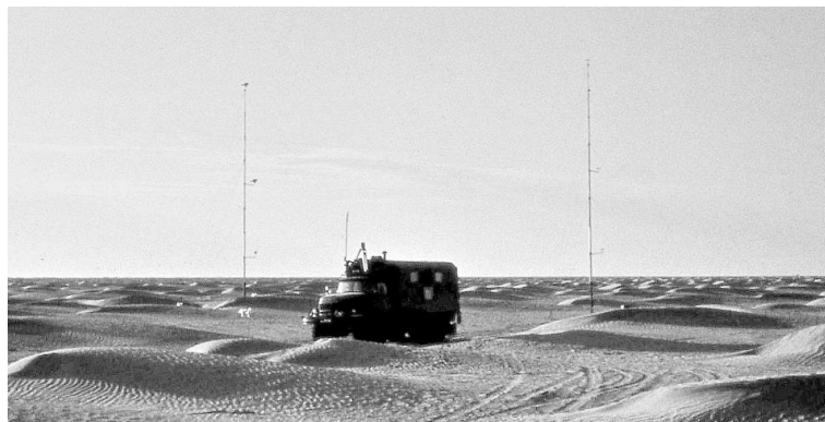
Рис. 2. Передвижная метеорологическая станция с метеорологическими мачтами для градиентных измерений на осушенном дне Арала.
