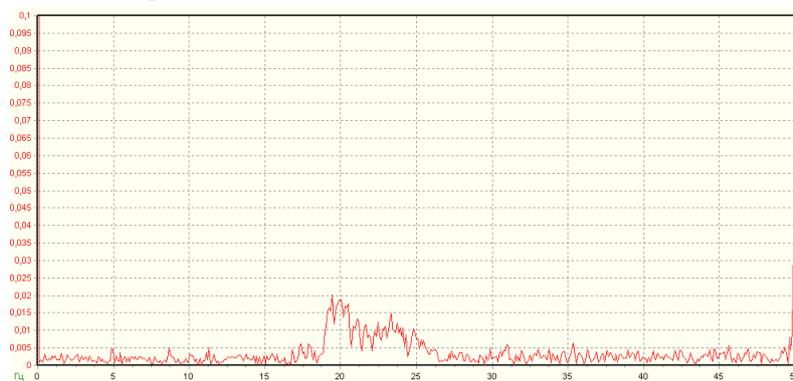
Рис. 1а. Изменение напряженности (В) между электродами в воздухе в зависимости от частоты (Гц).
